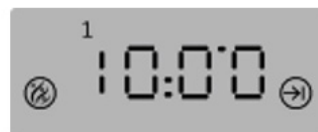
Interface de réglage de la fin de la période de chauffage 1
